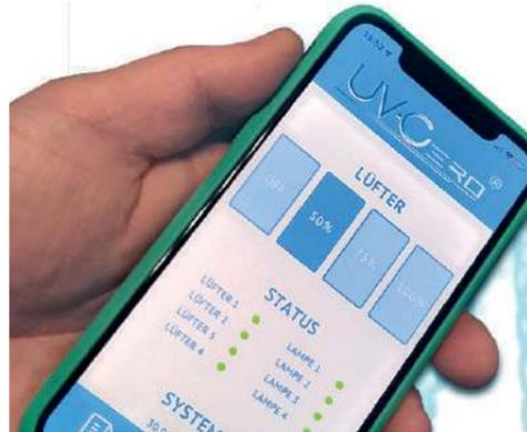
Deutsche Virologinnen, Virologen, Physikerinnen und Physiker haben die Luftdesinfektionsanlage UV-Cero 300 entwickelt. Deren Prinzip basiert auf der Zerstörung potenziell krankheitserregender Partikel in der Luft durch ultraviolettes Licht.
